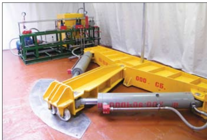
Рис. 7. Экспериментальный моделирующий комплекс для исследования динамических характеристик адаптивных гидроприводов
