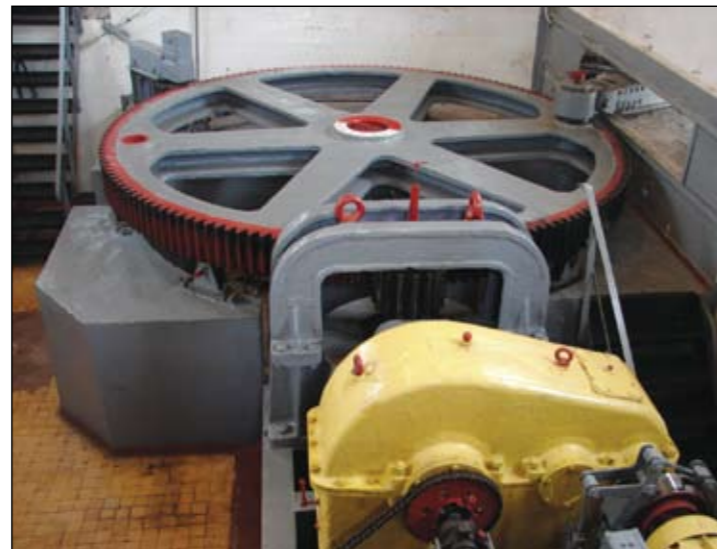
Рис. 6. Колесно-штанговый привод двустворчатых ворот
